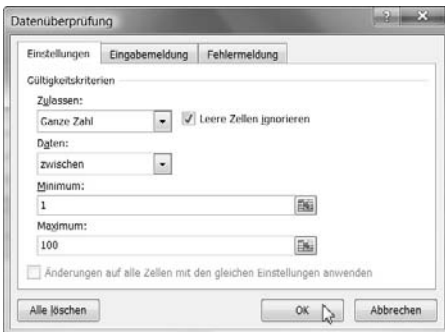
Bild 1.5: Die Funktion Gültigkeit lässt nur ganze Zahlen zwischen 1 und 100 in den markierten Zellen zu.
